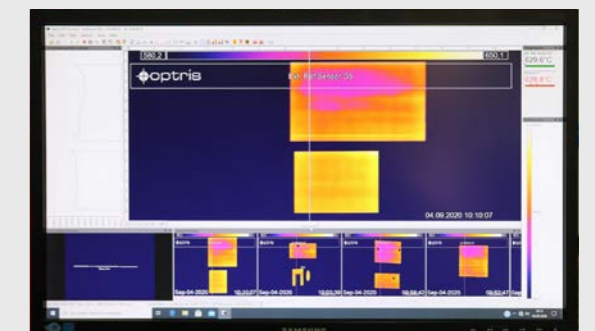
Überwachung der Temperaturen von Glasscheiben
